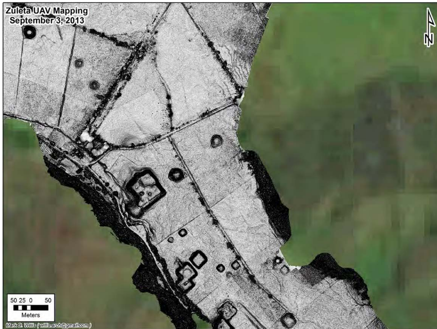
Figura 14. Mosaico de fotos aéreas del dron mostrando la parte sur intermedia (este) del sitio de montículos de la Hacienda Zuleta. Mapa preparado usando el MDE, basado en las imágenes de dron de 2013. Este mosaico usa la tecnología de realce de bordes para poner énfasis en los cambios de nivel del terreno para mostrar los montículos.
