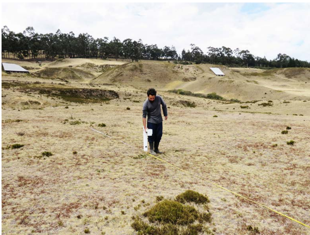
Foto 13. Cochasquí; plataforma del Montículo M en proceso de caminar transectos de un metro de ancho con el magnetómetro. Se puede notar el Montículo G con la rampa al fondo. Vista al noreste.
