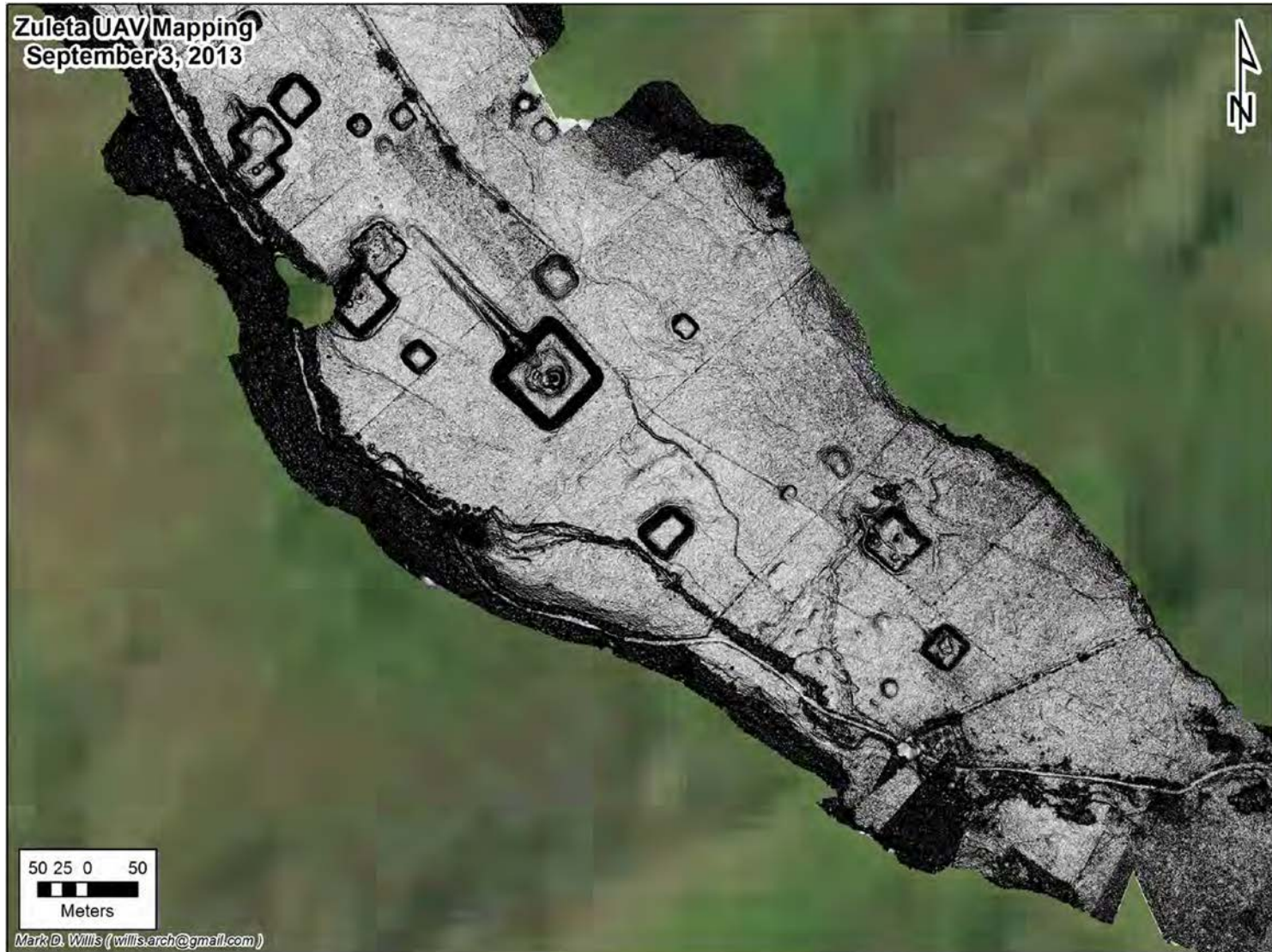
Figura 13. Mosaico de fotos aéreas del dron mostrando la parte sur del sitio de montículos de la Hacienda Zuleta. Mapa preparado usando el MDE, basado en las imágenes de dron de 2013. Este mosaico usa la tecnología de realce de bordes para poner énfasis en los cambios de nivel del terreno para mostrar los montículos.
