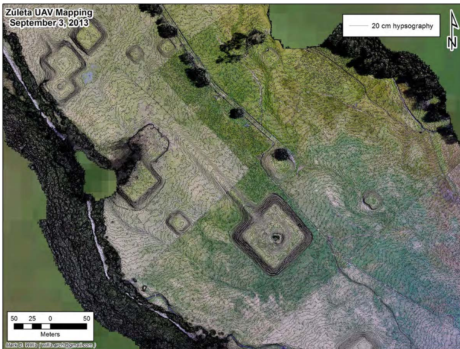
Figura 18. Este mosaico está un poco al norte de lo que se muestra en el mosaico de la Figura 17; las curvas de nivel están en incrementos de 20 cm.
