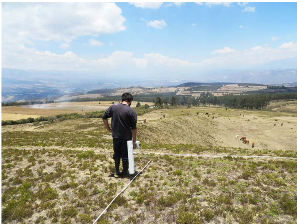
Foto 18. Cochasquí; Montículo K; en proceso de caminar transectos con el magnetómetro. Se puede notar la rampa al fondo.
